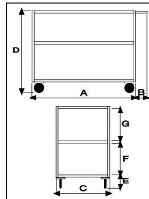
4 ruote girevoli, di cui 2 con freno in gomma antitraccia Ø 125
